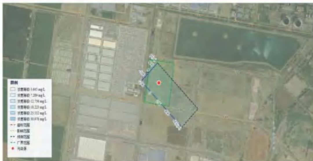
图 5.3.2-25-氨氮（以 N 计） t=100d 浓度等值线图
