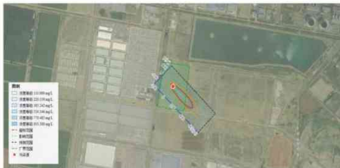
图 5.3.2-23 耗氧量（ \text{COD}_{\text{Mn}} 法，以 \text{O}_2 计） t=3650\text{d} 浓度等值线图
