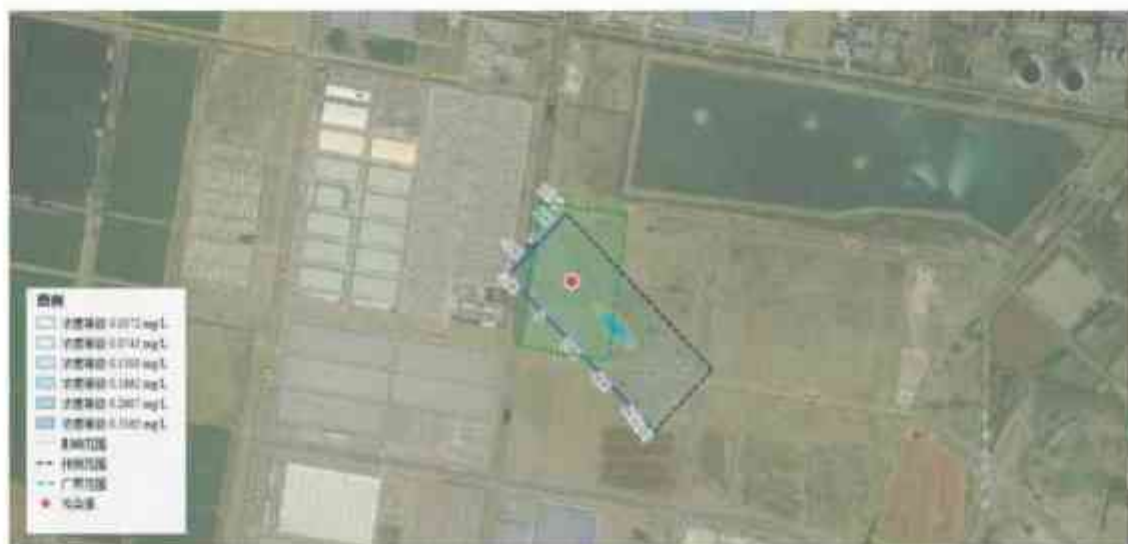
图 5.3.2-5 耗氧量 ( \text{COD}_{\text{Mn}} 法, 以 \text{O}_2 计) t=3650\text{ d} 浓度等值线图
