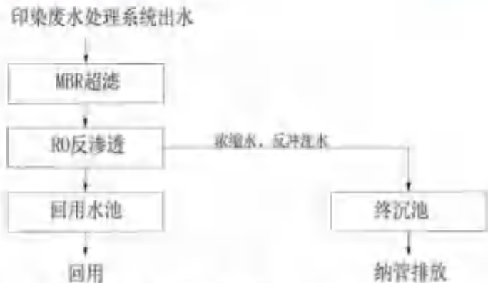
图 6.2.2-3 污水处理站及中水回用装置工艺流程图
