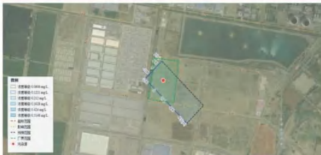
图 5.3.2-7 氨氮（以 N 计） t=100d 浓度等值线图
