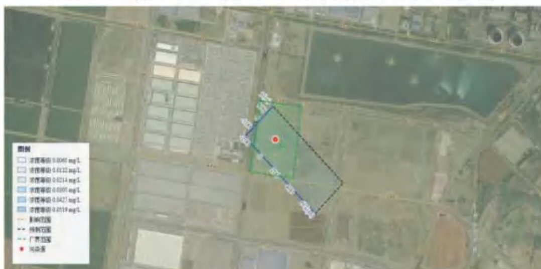
图 5.3.2-9-氨氮（以 N 计） t=1000d 浓度等值线图
