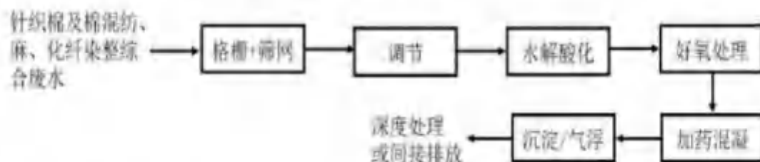
图 6.2.4-2 针织、混纺及化纤染整综合废水常规处理工艺流程示意图
