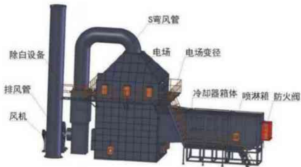
图 6.1.1-4 “间接冷却+静电净化”设备示意图
