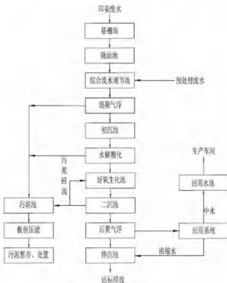
图 6.2.2-2 印染废水处理系统工艺流程
