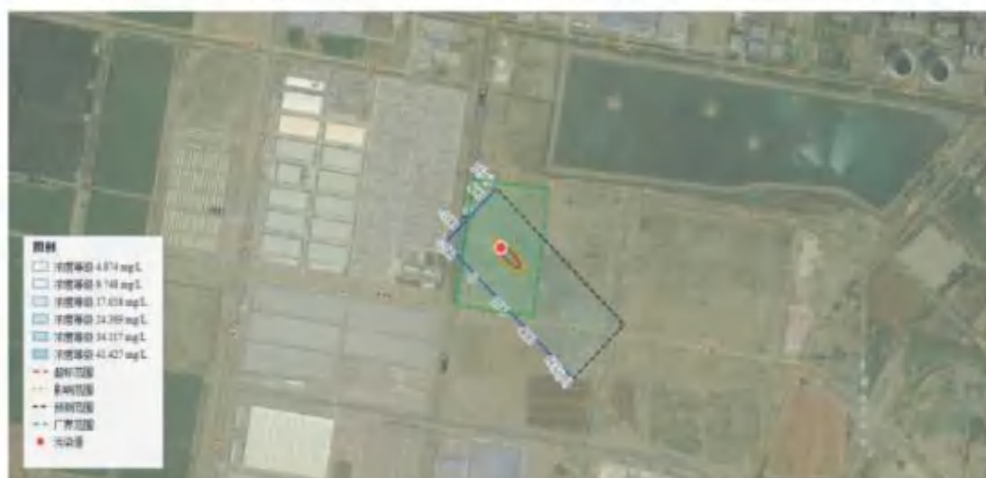
图 5.3.2-27 氨氮（以 N 计） t=1000d 浓度等值线图
