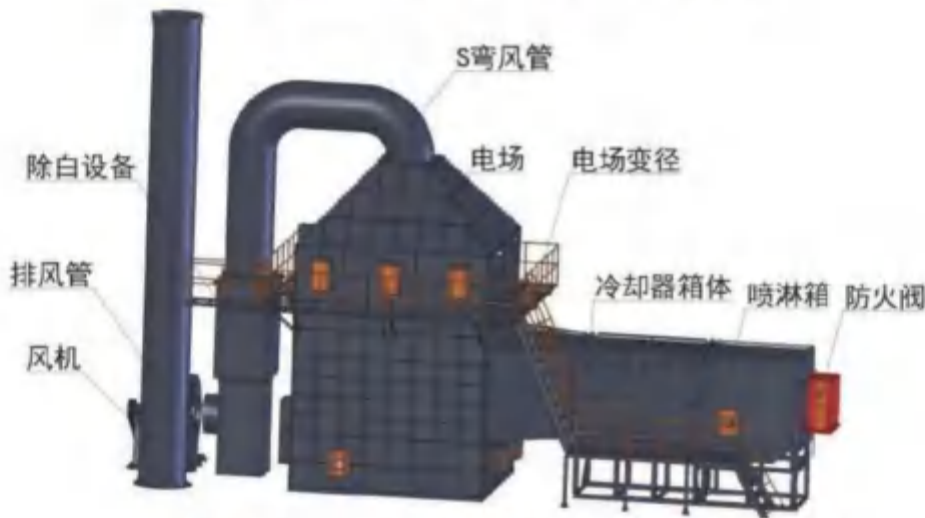
图 6.1.1-4 “间接冷却+静电净化”设备示意图
