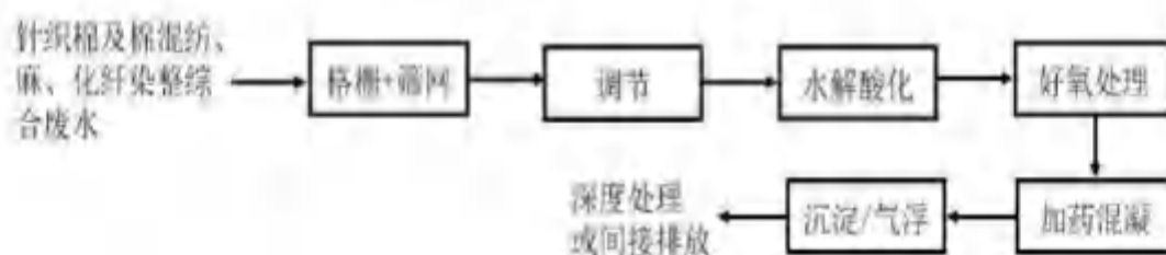
图 6.2.4-2 针织、混纺及化纤染整综合废水常规处理工艺流程示意图
