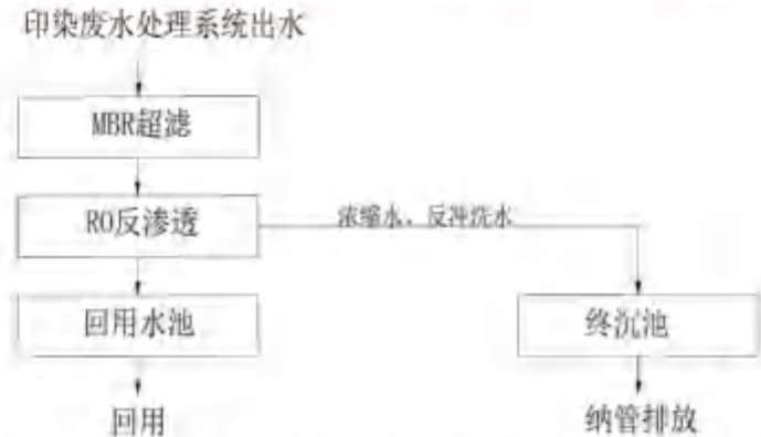
图 6.2.2-4 污水处理站及中水回用装置工艺流程图
