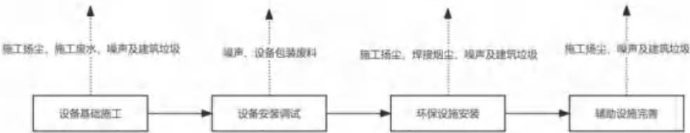
图2-2 施工期工艺流程及产污环节图
