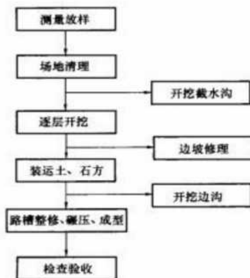
图 2-4 挖方路基施工流程图
