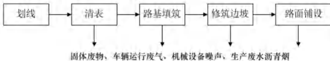
图 3.1-44 道路施工工艺及产污环节
