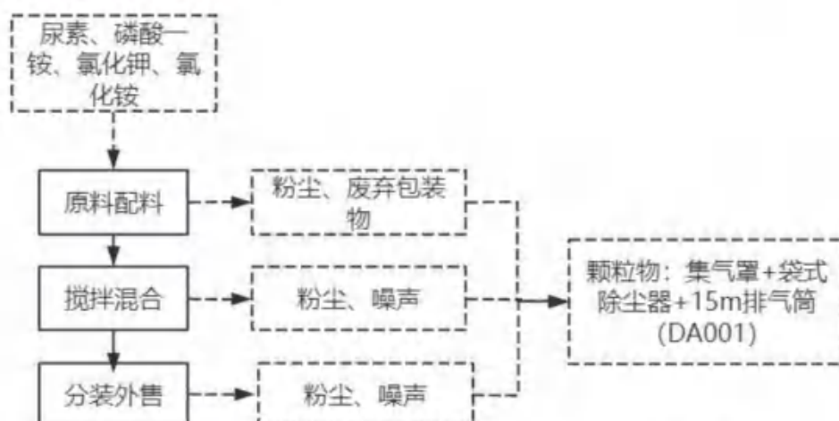
图 2-5 掺混肥生产线工艺流程及产污节点示意图
