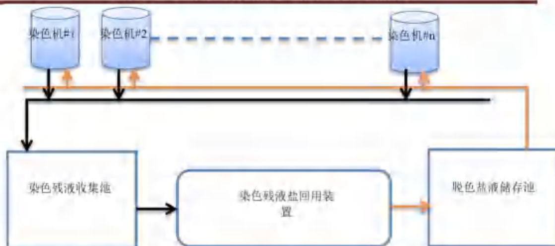
图 6.2-6 活性染料染色残液盐回用装置与染色机循环系统结构示意图
