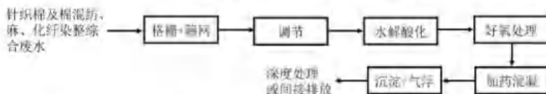
图 6.2-12 针织棉及棉混纺染整等综合废水常规处理工艺流程示意图
