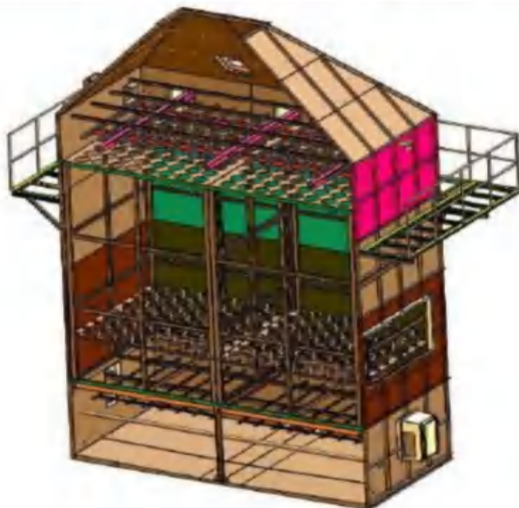
图 6.1-2 静电除油内部结构图
