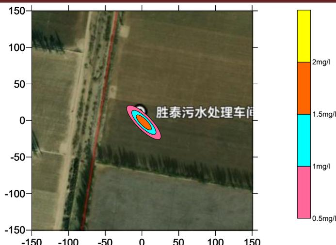
图 5.3-7 COD 短时泄露 3650d 浓度等值线图（泄漏量 10m<sup>3</sup>）
