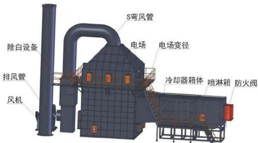
图 6.1-4 “水喷淋+间接冷却+静电净化”设备示意图
