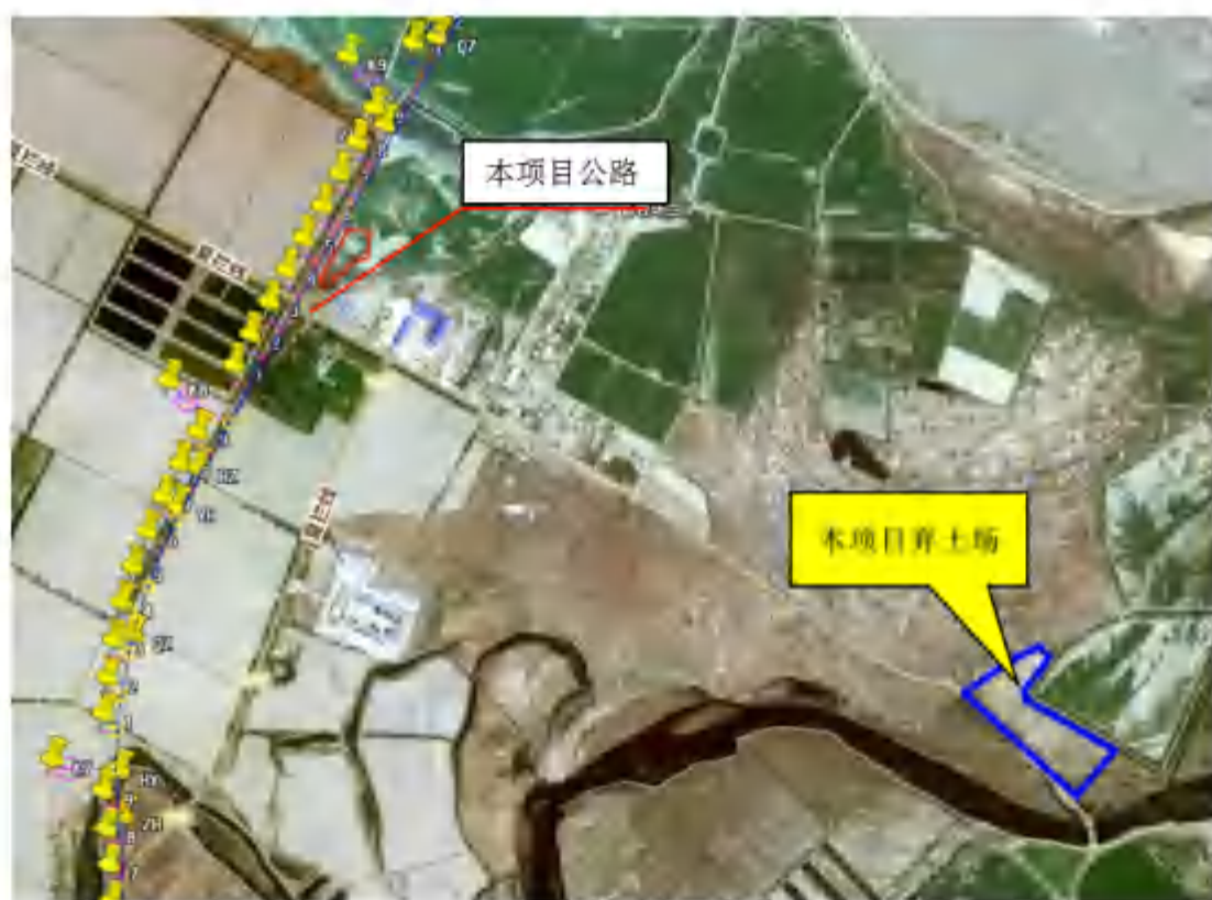
图 3.1-28 本项目弃土场遥感影像图
