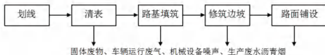
图 3.1-32 道路施工工艺及产污环节
