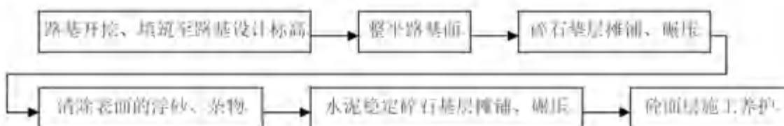
图 3.1-31 路面施工工艺
