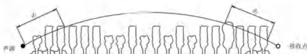
图 5.4-3 通过树和灌木时噪声衰减示意图
