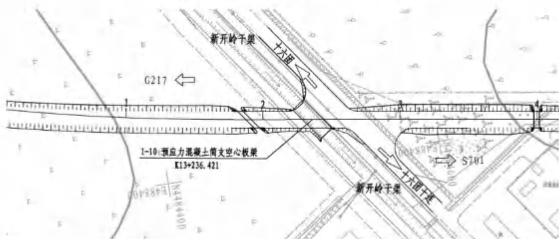
图 3.1-24 新开岭干渠小桥桥位平面图
