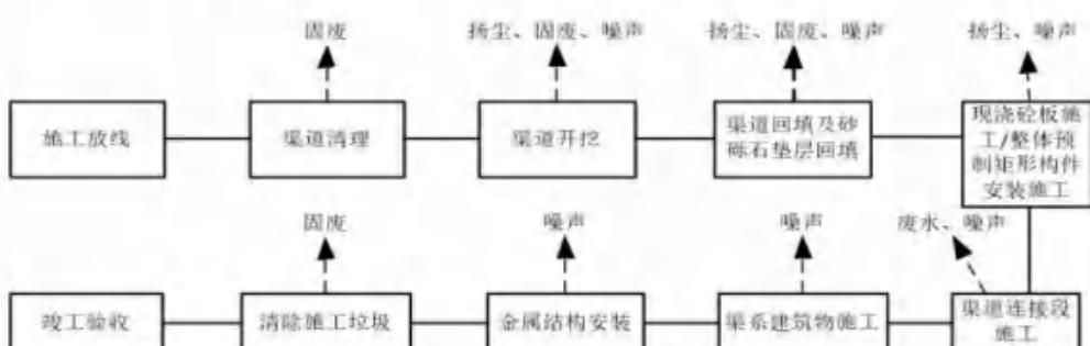
图 2-5 斗渠防渗工艺流程图
