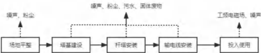
图 1.1 项目工艺流程及产污环节图
